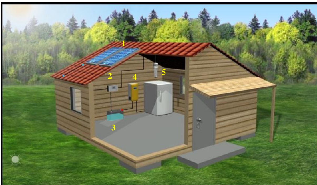
Rys.3.2 Autonomiczna instalacja fotowoltaiczna. 1 – ogniwa fotowoltaiczne, 2 – kontroler ładowania, 3 – akumulator(y), 4 – inwerter, 5 – odbiorniki energii elektrycznej
