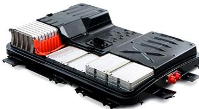
Rys. 11.7 Wymienna bateria akumulatorów montowana w podłodze samochodu Nissan Leaf [11.9]
