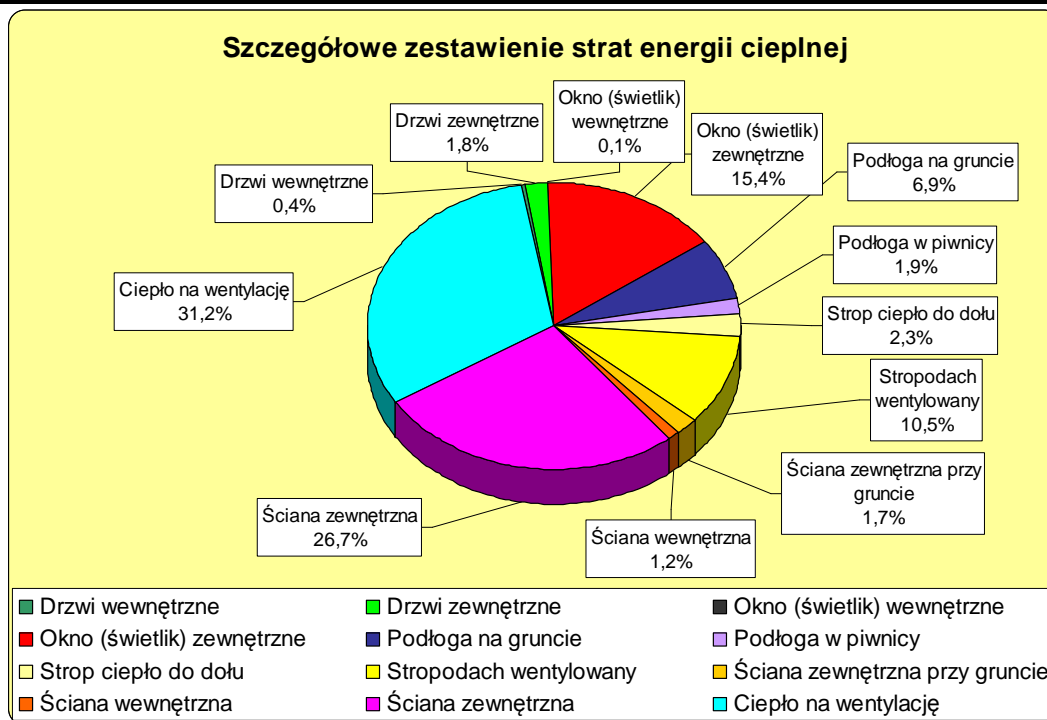
Rys. 2.2. Zestawienie udziału strat ciepłych poszczególnych elementów budynku w stratach całkowitych w sezonie grzewczym- stan przed termomodernizacją.
