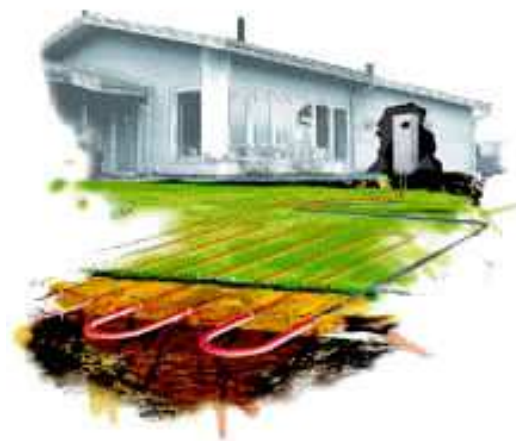
Rys. 3.1. Pompa ciepła z wymiennikiem gruntowym – kolektor poziomy
