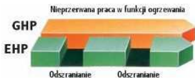
Rys.2 Praca GHP bez przerw na odszranianie
