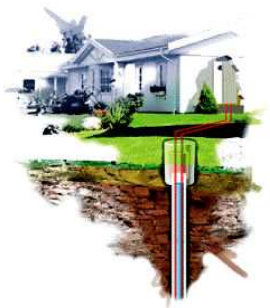
Rys. 3.2. Pompa ciepła z wymiennikiem gruntowym – kolektor pionowy
