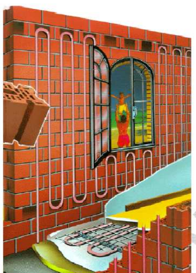
Rys. 4.1. Ogrzewanie ścienne i podłogowe (Stallaerts)
